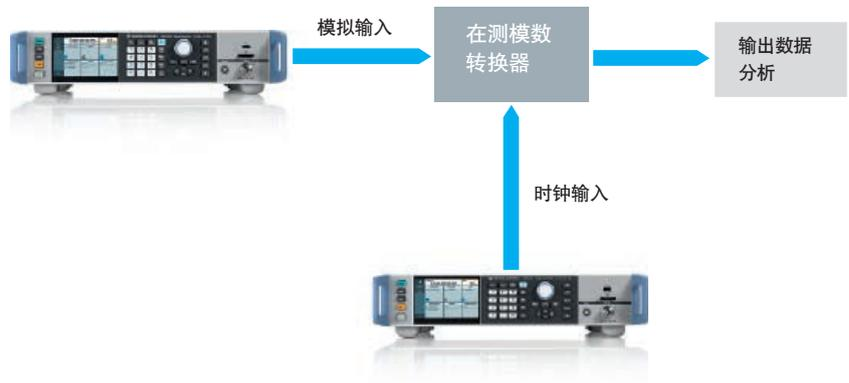
采用具有集成第 2 信号源的单台 R&S®SMA100B 的紧凑型模数转换器测试装置。
