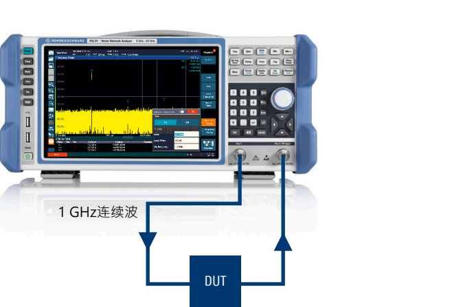
使用0 dBm (1 GHz时) CW输入信号的共模变压器输出信号频率扫描。
