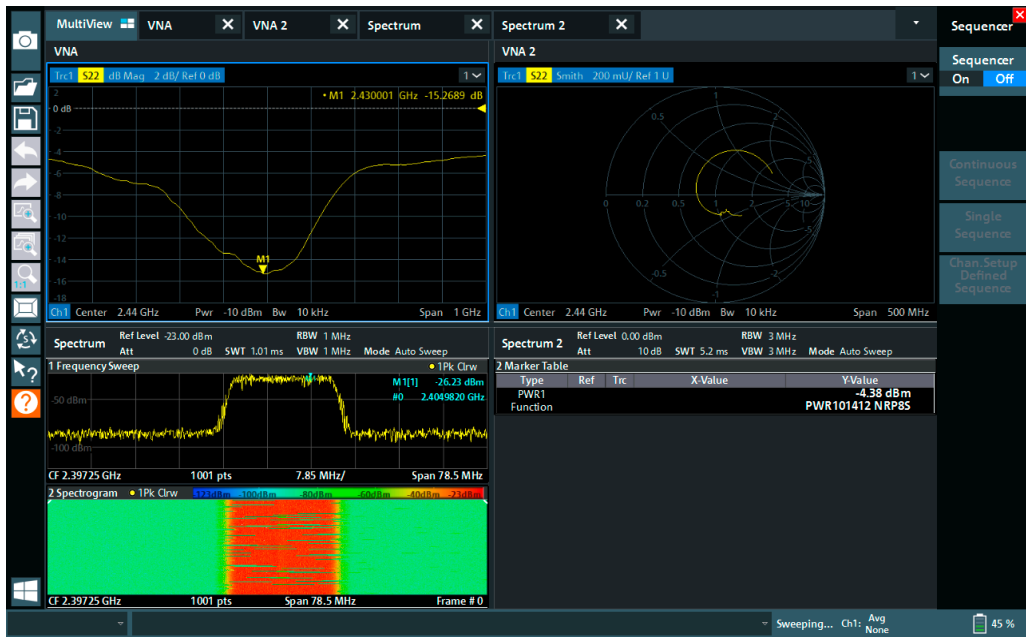
多视图模式同时显示所有活动测量。图中同时显示矢量网络分析仪测量（两个不同的显示图）和频谱分析仪测量。
